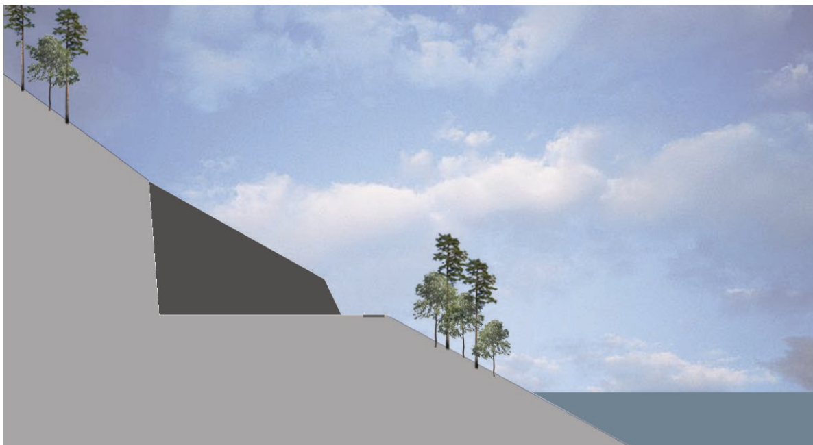
Figur 14: Illustrasjonen viser et snitt gjennom området med transformator og bryteranlegg, der den kamouflerende virkningen til skogen nedenfor anlegget er tydelig. Anlegget er vist skjematisk og er noe mer omfangsrikt enn anlegget reelt vil bli.
